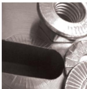
フランジナットとSPワッシャーの併用により、長穴の場合は接地面積を広げることができ、相手材が柔らかい場合は単位面積当たりの面圧を下げるすることができます。右記寸法表にて「NL●●spss-254」と表記されているものが幅広の製品となります。
