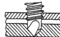
刃先が前進する速度とねじ山が一山進む速度の違いで締結物が浮いたり圧力が掛かりすぎて刃先が破損したりします。
