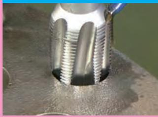
③治具を使ってインサートの取付け
