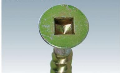
四角穴が開いた頭部形状で、十字穴の弱みであるビット抜けを防ぐ効果があります。天井工事や横打ちの際に倒れや抜けを防ぎます。
