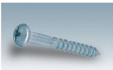
木ねじには、首下から約1/3の胴太ねじなし部があります。天然の木材の収縮性を利用し、ねじの無い胴太部で押し広げられた木材が後に収縮して挟み込まれて抜けにくくなります。近年は収縮性の無い加工材の増加により使用量が減少しています。
