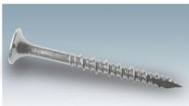
高いねじ山と低いねじ山の2条ねじの構造です。高いねじ山で保持力を確保し、低いねじ山で打ち込みの安定性を高めます。万能ビス、コンクリート用ビス等に採用されています。
