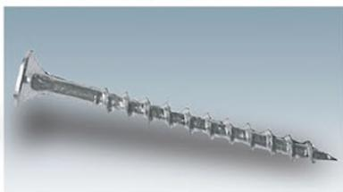
コーススレッド (Coarse) 目の荒い (Thread) 1本の線 (1条ねじ) の意味です。1条ねじでねじ山が高く、ピッチが広い為、保持力に優れた特性があり、先端の尖りで下穴無しで木材に打ち込むことが出来ます。
