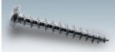
柔らかくねじが効きにくいパーチクルボード、MDF用に開発されたねじです。細い谷径が、柔らかい材質を押しつぶさず入り込み、ねじ山が引き抜き方向に反り返っている為、低トルクと抜群の保持力を実現しています。また、ねじの先端までねじ山が立っているのですべらずに打ち込みが可能です。
